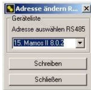
**Bild 46.** Das Fenster der Adressänderung eines im RS485 Netzwerk betriebenen Analysators.
