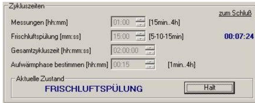
**Bild 54.** Information über den aktuellen Zustand des Gerätes.
