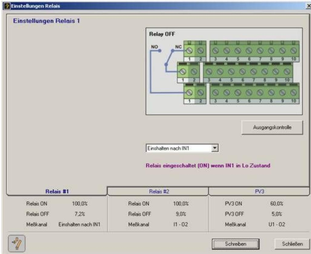
**Bild 60.** Einstellungen des Relais mit dem IN1 Eingang als Signalquelle.
